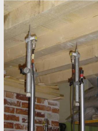
TRASDUTTORI SU ASTE TELESCOPICHE PER IL RILIEVO DELL'ABBASSAMENTO DELLE TRAVI DEL PRIMO SOLAIO
