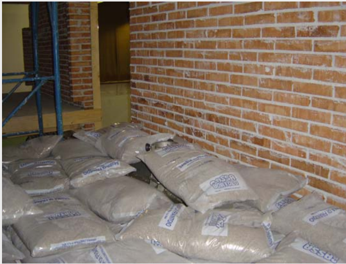
APPLICAZIONE DI CARICO DISTRIBUITO DI 100-200 E 300 KG/M2 COSTITUITO DA SACCHI DI SABBIA
