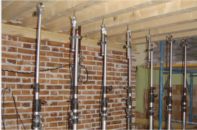
TRASDUTTORI SU ASTE TELESCOPICHE PER IL RILIEVO DELL'ABBASSAMENTO DELLE TRAVI DEL PRIMO SOLAIO
