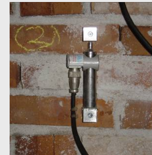
DEFORMOMETRI INSERITI NELLO SPESSORE DEL PIEDE MURARIO PER IL RILIEVO DELLO SCHIACCIAMENTO
