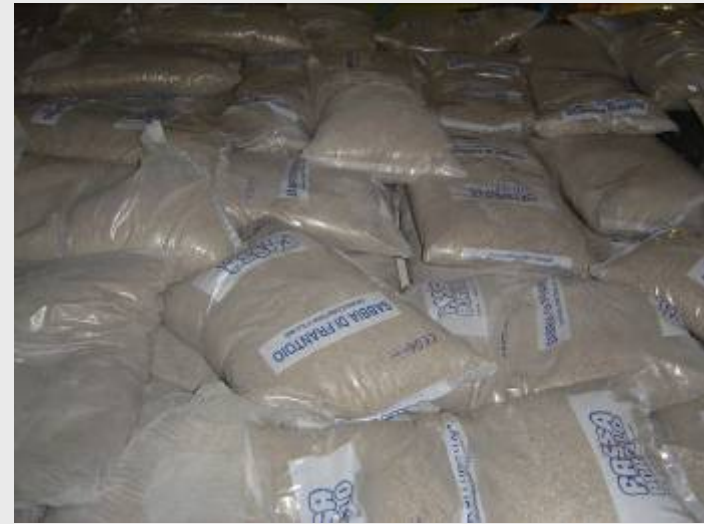
APPLICAZIONE DI CARICO DISTRIBUITO DI 100-200 E 300 KG/M2 COSTITUITO DA SACCHI DI SABBIA
