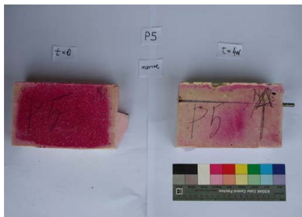
Carbonatazione delle superfici esposte: prova della fenolftaleina
