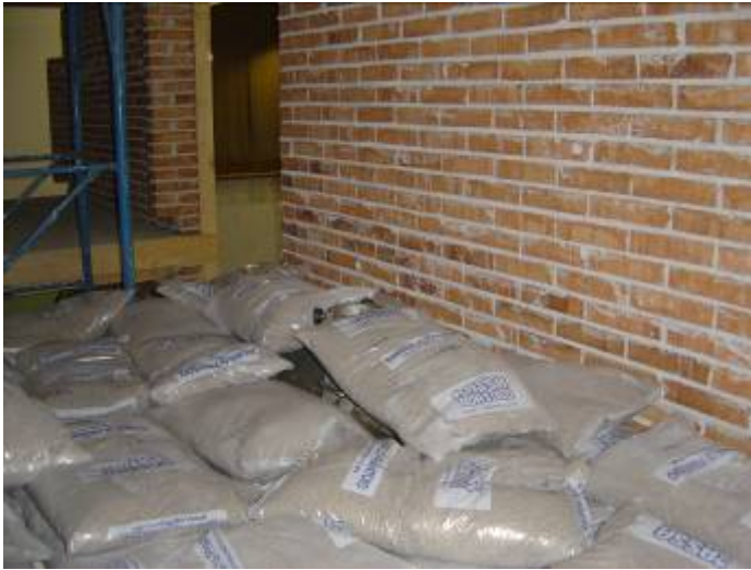
Carico distribuito di 100-200-300 kg/m 2 costituito da sacchi di sabbia
